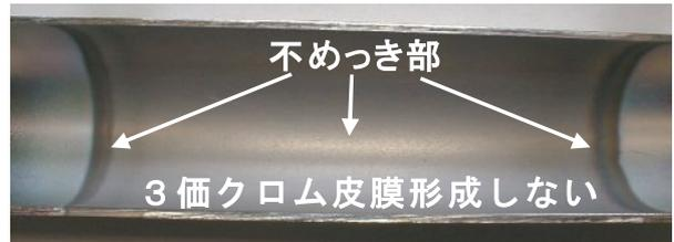
\* 3価クロムは鉄とは結合しないため、鉄が露出している
